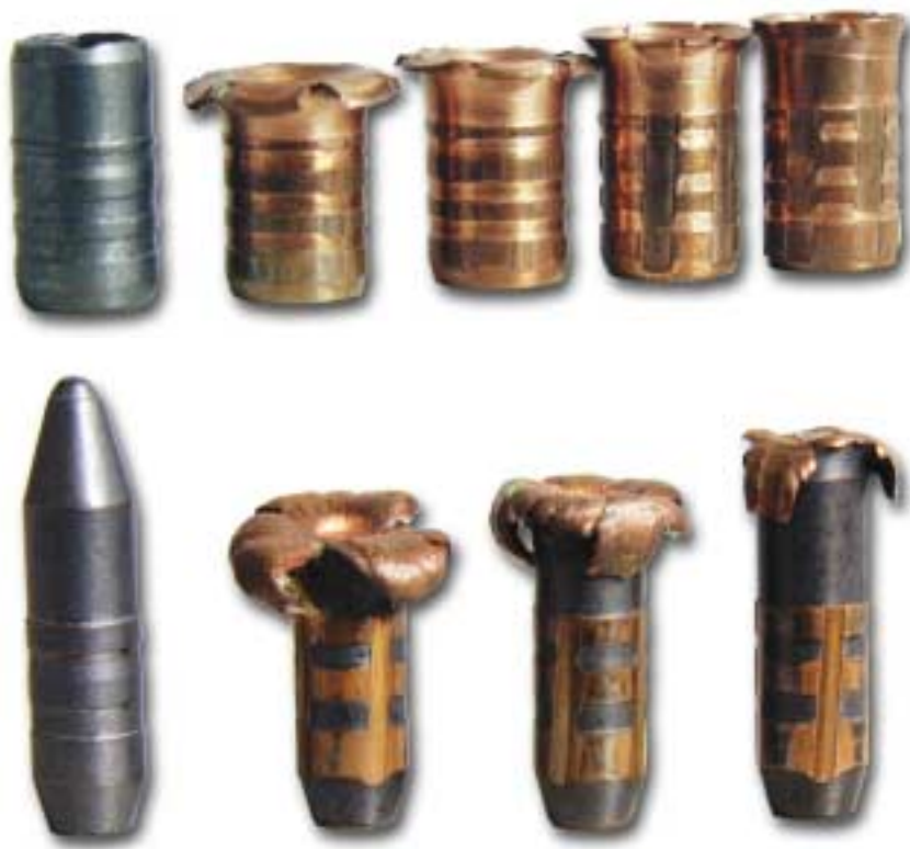
Aufgepilt: Zwei HDB-Varianten vor und nach dem Schuss. Oben das Fangschuss-HDB, unten das Universal-HDB, jeweils bei unterschiedlichen Zielgeschwindigkeiten
